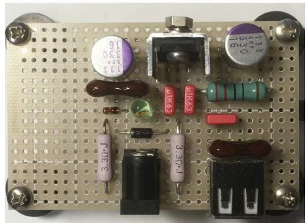
抵抗の  $3.3\Omega$  の抵抗、 $220\Omega$  の抵抗は、ワット数が大きいので発熱があると思い、基板から  $1\text{mm}$  ほど浮かして取り付けた。部品を装着するとき、基板の切れ端を挟んで浮かす高さを揃えている。
