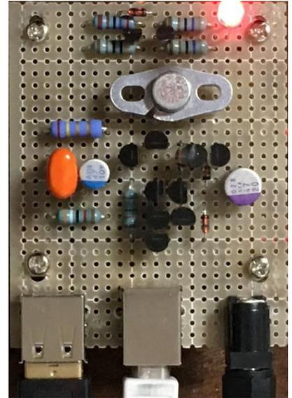
基板の右上は、電源スイッチが当たってしまうのでカットした。また、取付金具用のビス穴位置も変更した。
